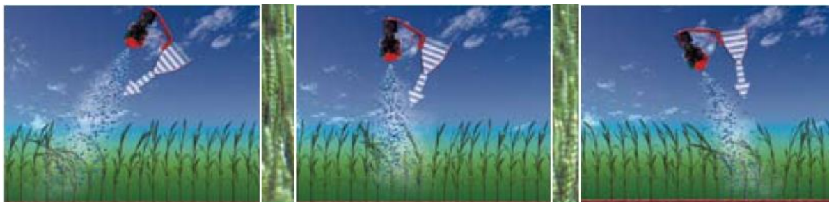
Slika 13.24: Prikaz mogućnosti mijenjanja kuta kod „TWIN“ sustava (Izvor: www.hardi-interacional.com )
