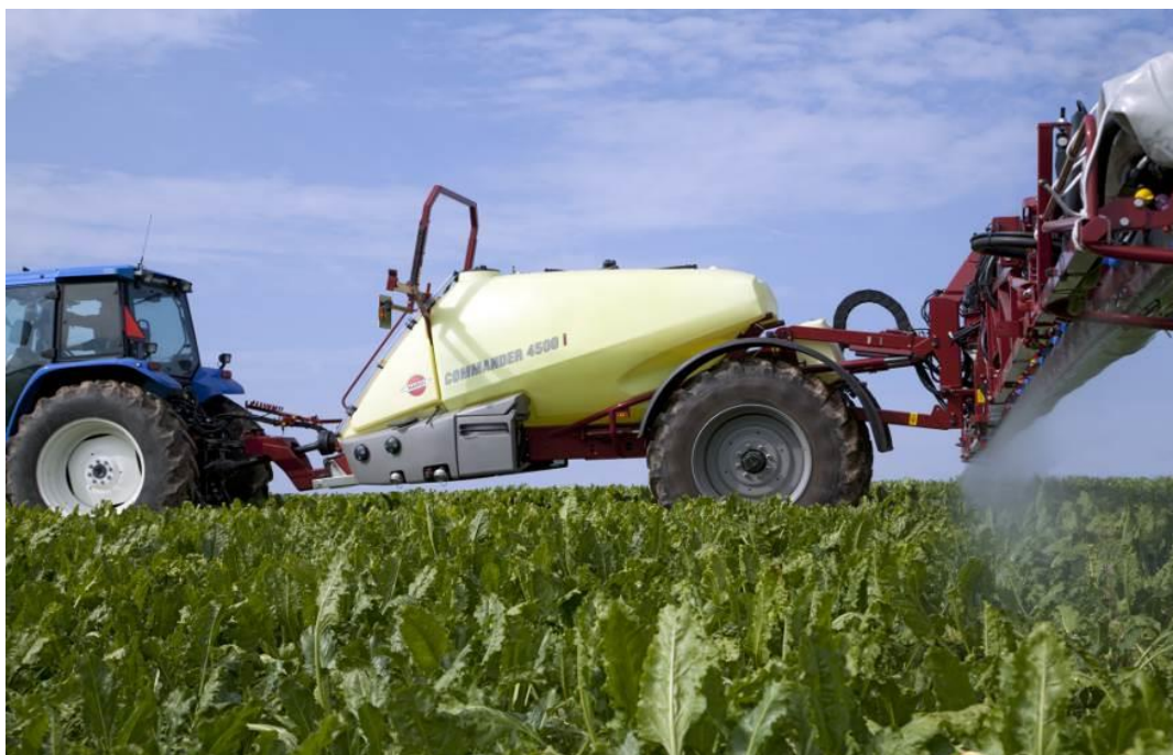
Slika 13.23: Prskalica sa zračnom potporom "HARDI TWIN" (izvor: www.hardi-interacional.com )
