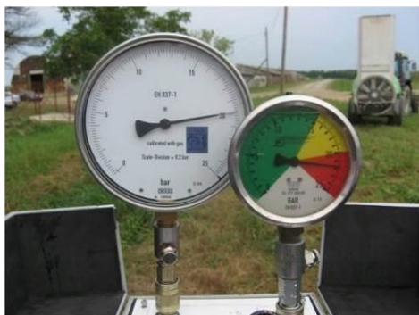
Slika 13.1: Kontrola ispravnosti manometra (izvor: www.amazone.com )
