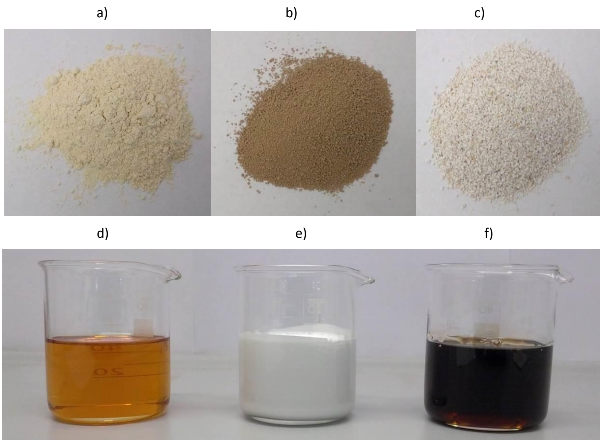
Slika 5.2: Različite vrste krutih i tekućih formulacija: a) močivo prašivo (WP); b) močive granule (WG); c) granule za izravnu primjenu (G); d) koncentrat za emulziju (EC); e) koncentrirana suspenzija (SC); f) koncentrat za otopinu (SL) (snimila: M. Pelajić)
