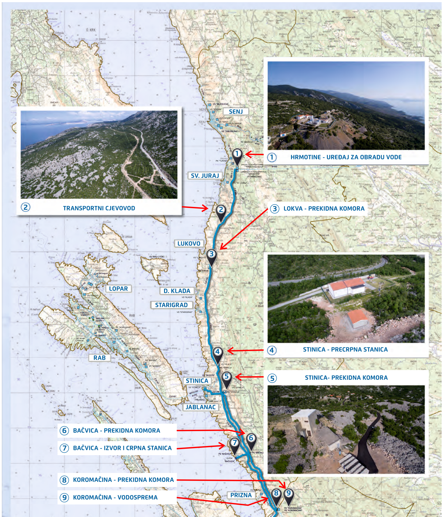
Prikaz djela vodovoda sa prekidnom stanicom Stinica odakle se pruža podvodni cjevovod do prekidne stanice Barbat
