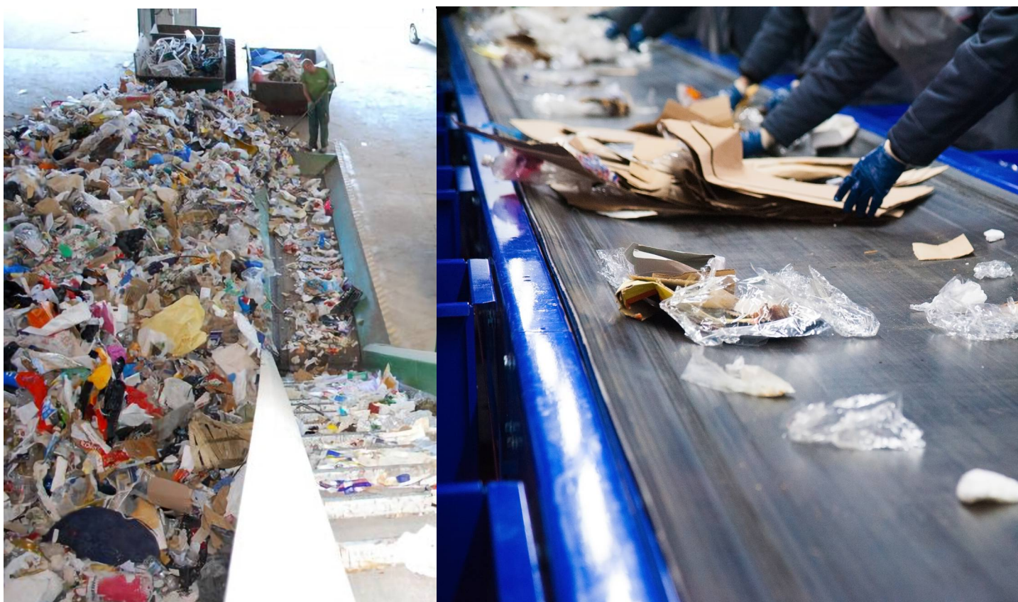
Dodatno odvajanje korisnih frakcija otpada
