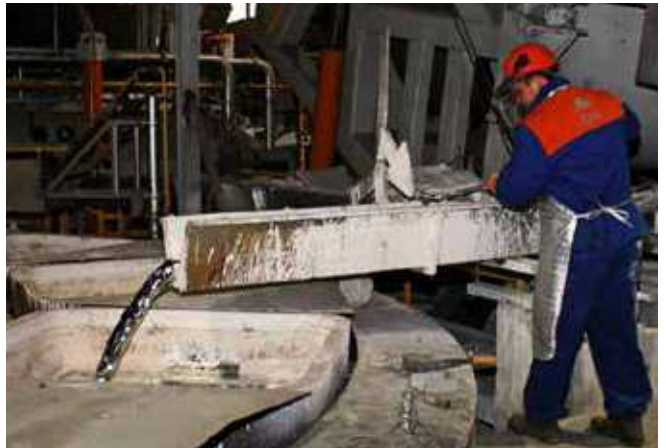
Ispuštanje lijeva iz peći
