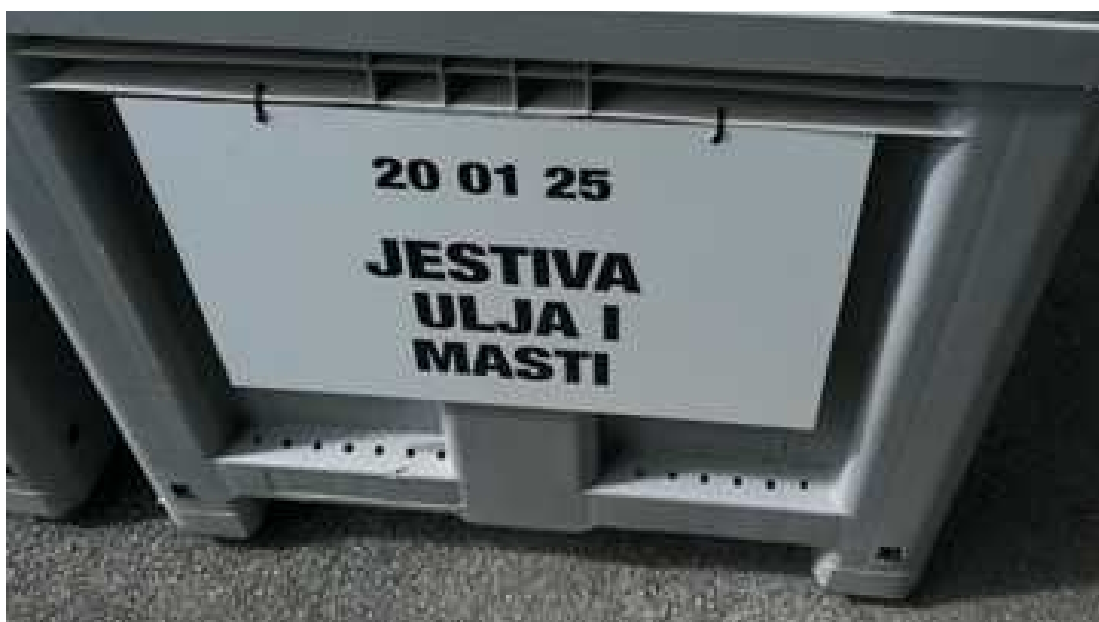
Nepropusni spremnik za skupljanje otpadnih jestivih ulja i masti na reciklažnom dvorištu
