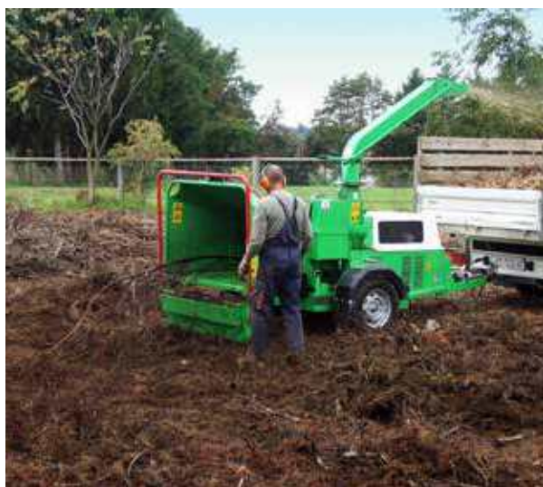
Prije kompostiranja granje se strojno usitnjava – sječka
