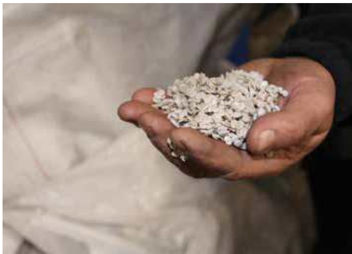
Granulat nastao usitnjavanjem otpadnog polietilena
