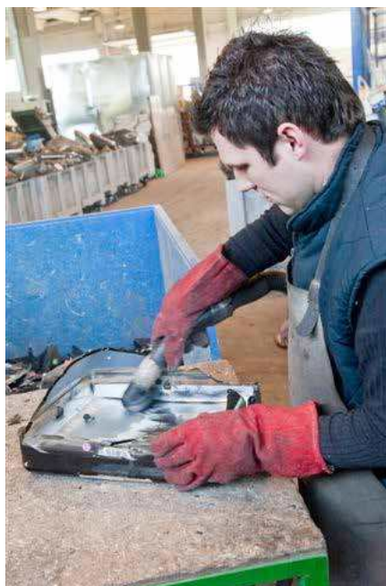
Odstranjivanje fosfora s unutarnje stjenke tv ekrana
