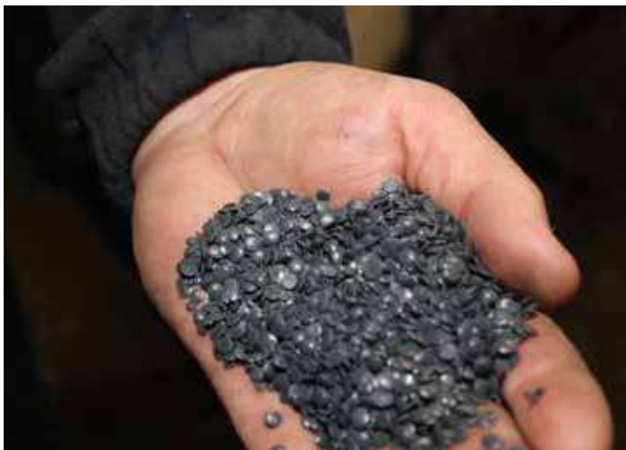
Granulat nastao usitnjavanjem otpadnog polietilena
