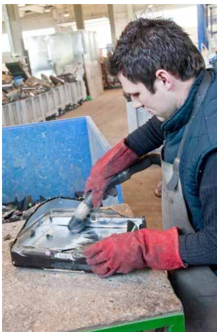
Odstranjivanje fosfora s unutarnje stijenke tv ekrana
