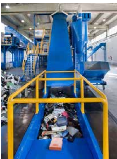
Stavljanje EE otpada u usitnjivač
