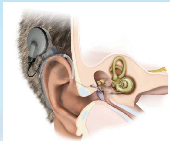
Primjer ugrađene umjetne pužnice
